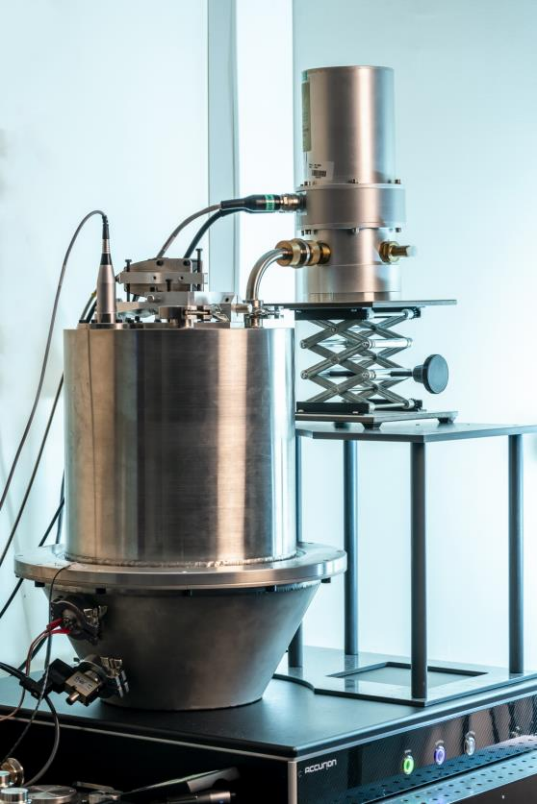
LNE (laser) pistonphone
