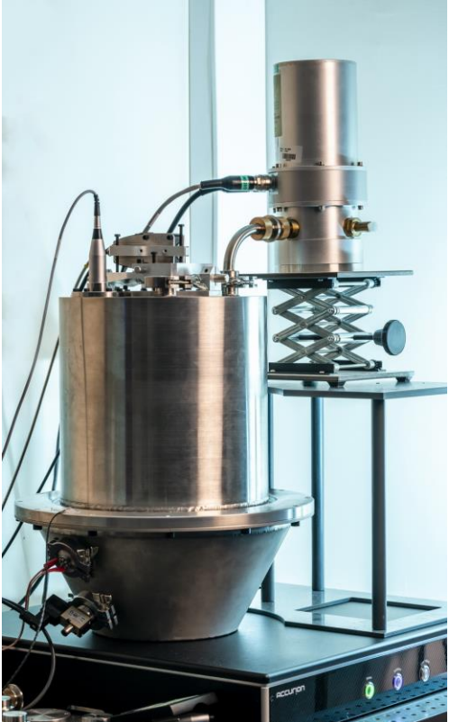
LNE (laser) pistonphone
